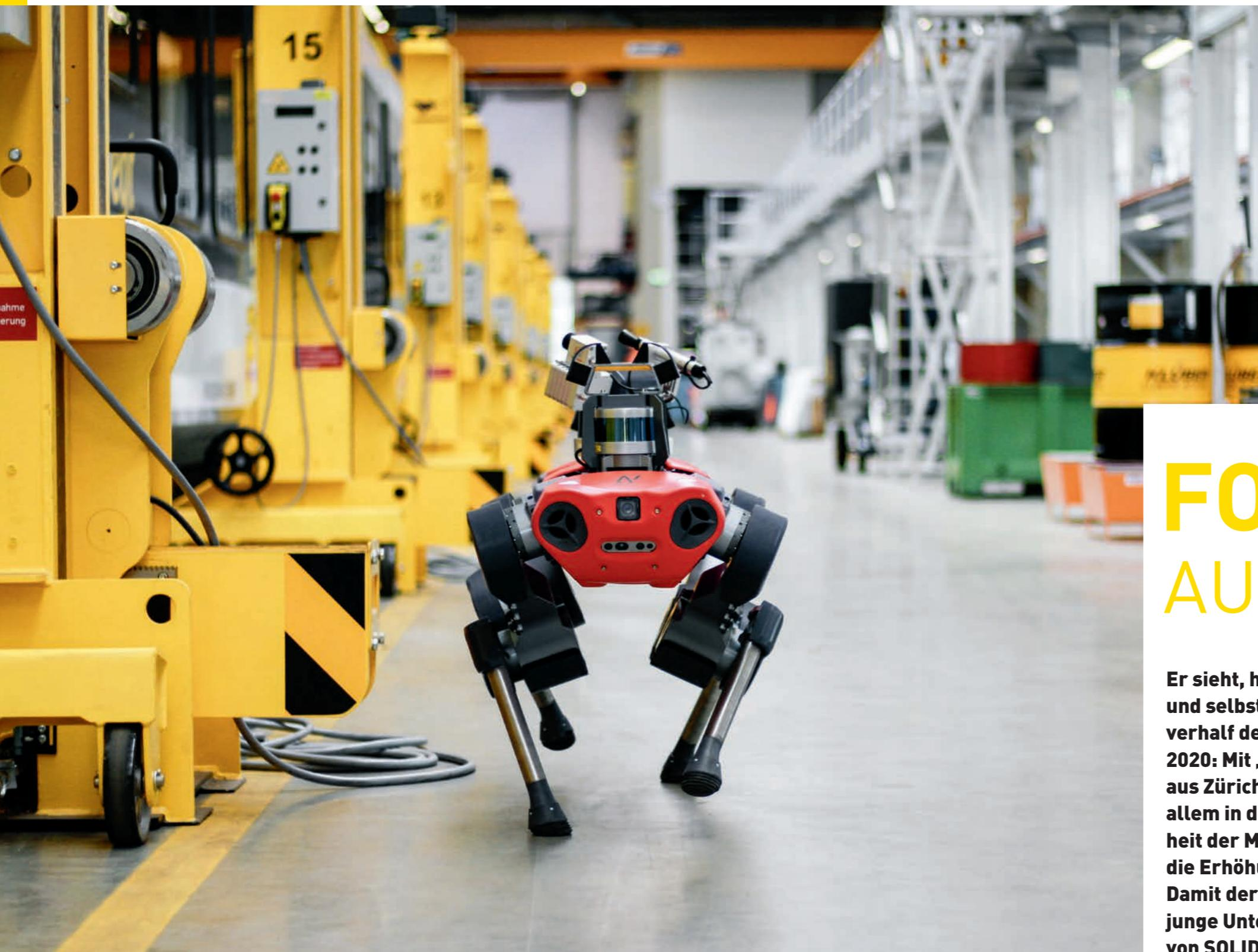
ANYmal C ist ein Inspektions-roboter, der vollautonom durch Anlagen streift und Routine-kontrollen durchführt.
